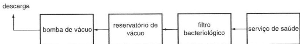
Figura D.2 – Esquema de instalação de vácuo
